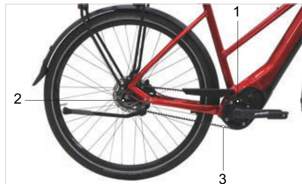
Illustration 47 : Schéma de l'entraînement à courroie
