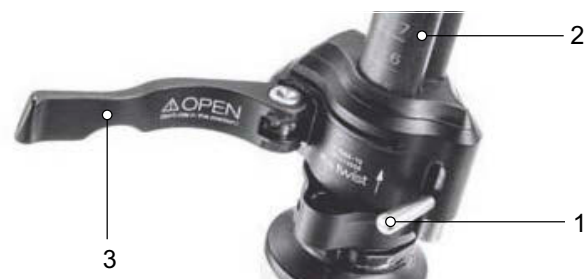
Illustration 169 : Levier de serrage ouvert de l'attache rapide de la potence (3) sur la potence (2), modèle I, avec levier de blocage sur la potence (1)
