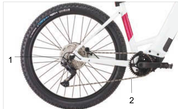
Illustration 46 : Schéma de l'entraînement à chaîne avec dérailleur
