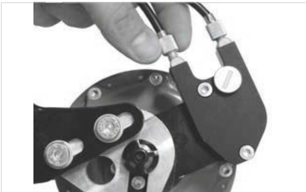
Illustration 197 : Sur les versions de moyeux ROHLOFF avec commande externe du changement de vitesse, le dispositif de réglage de la tension est situé sur le boîtier de câbles qui est placé sur le côté gauche
