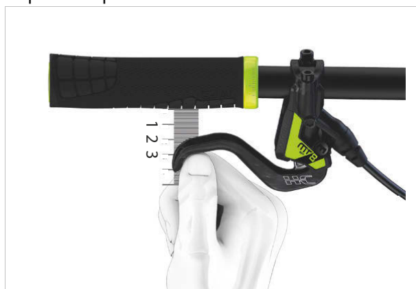
Illustration 114 : Positionnement du frein à main
