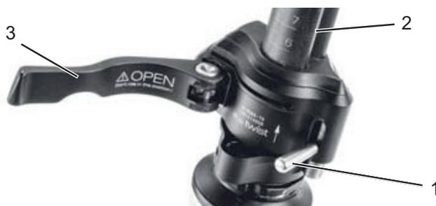
Illustration 49 : Levier de serrage ouvert de l'attache rapide de la potence (3) sur la potence (2), modèle I, avec levier de blocage sur la potence (1)
