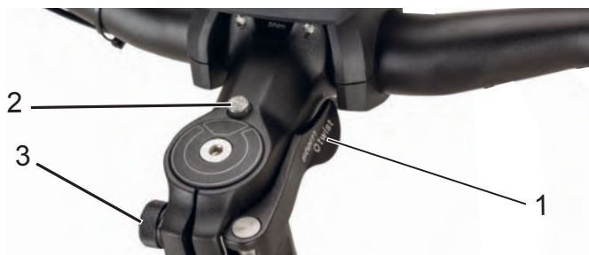
Illustration 15 : Potence, modèle II avec levier de serrage (1), bouton de déblocage (2) et écrou moleté (3)
