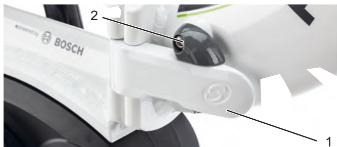
Illustration 33 : Cadre, avec levier de serrage du cadre fermé (1) et levier de blocage du cadre fermé (2)
