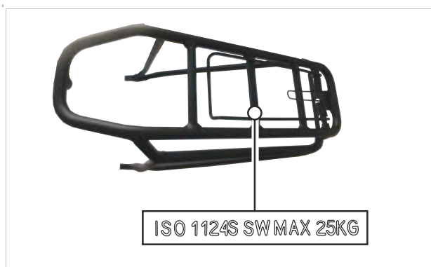
Afbeelding 149: Op de bagagedrager staat het maximale draagvermogen vermeld
