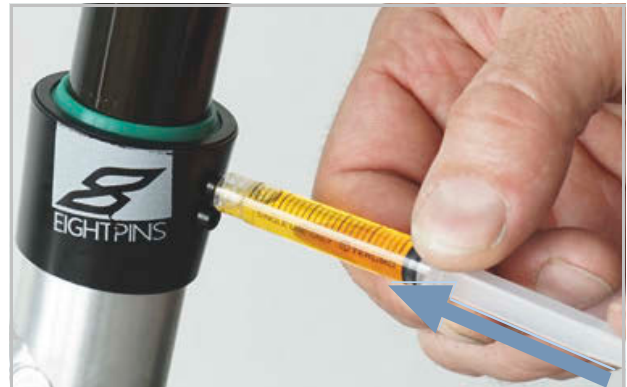
Afbeelding 178: EIGHTPINS zadelpenbus smeren
