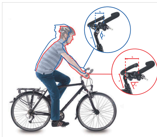
Afbeelding 107: Stadsfiets- (blauw) en toerfietsstand (rood) door verandering van de hoek
