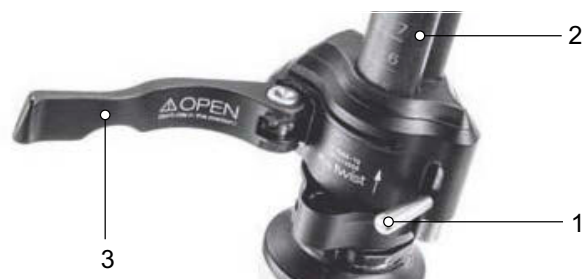
Afbeelding 169: Geopende spanhendel van de snelspanner (3) op de voorbouw (2), uitvoering I, met vergrendelhendel op de voorbouw (1)
