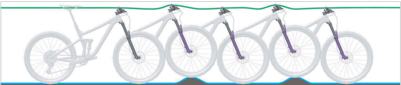
Afbeelding 18: Optimaal rijgedrag van de verende voorvork
