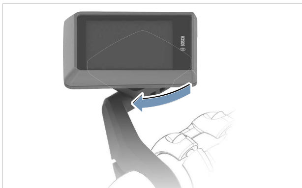
Afbeelding 135: Display rechtsonder draaien
