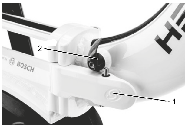
Afbeelding 171: Gesloten (1) en geopende (2) framevergrendelhendel
