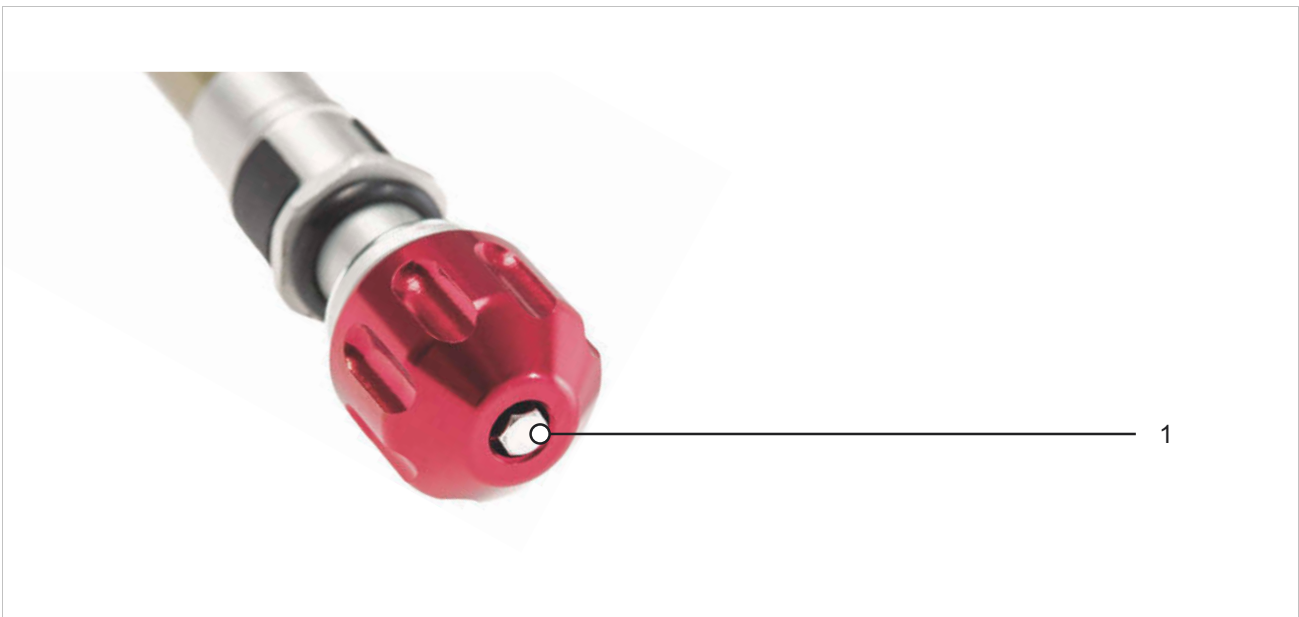
Afbeelding 206: Voorbeeld SR SUNTOUR trekdemperafsteller (vork) (1)
